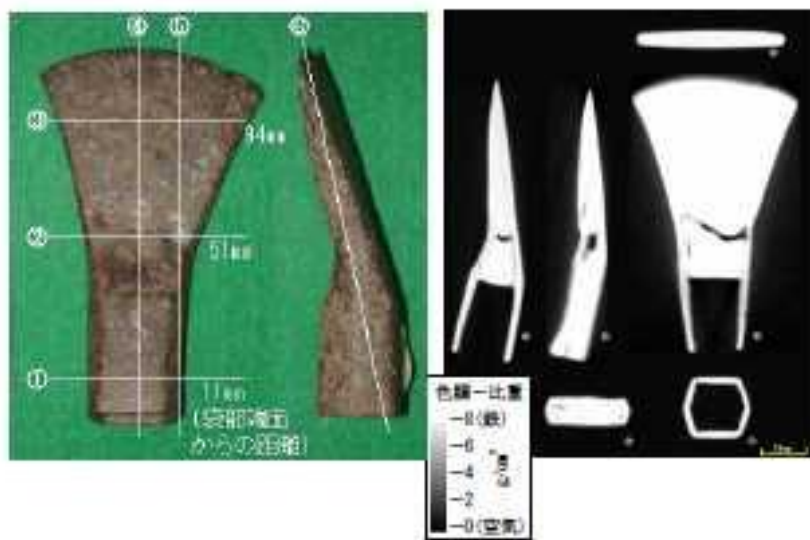
約750年前の埋没鉄器の鋌(鐮:チョウナ) (左)とそのX線CT画像(右) 出典:核燃料サイクル開発機構 東海事業所 処分研究部「人工バリア等のナチュラルアナログ研究」図1
