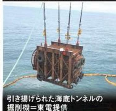
引き揚げられた海底トンネルの掘削機＝東電提供
