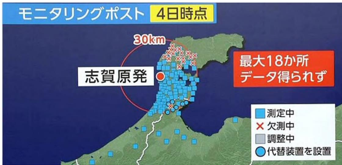
原発事故の際には、モニタリングポストで計測される放射線量を確認して避難指示が出される。可搬式計測器があるが、道路が通行できなければ放射線量を把握できない事態に！
